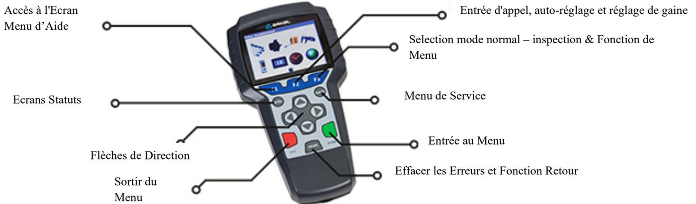
Figure-8b : Console de Paramétrage - AREM
